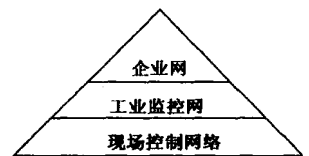
图 1 企业综合自动化系统结构层次示意图
